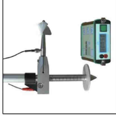
Figure 12 : Matériel de jaugeage utilisé (micro-moulinet SEBA M1 et compteur Z6)
